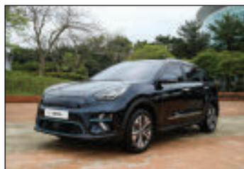
EV repose sur de nouvelles jantes en alliage d'aluminium de 17 pouces à cinq branches, dotées d'une finition diamant bicolore et abritant le système de freinage par récupération de Kia. Sa caisse d'une largeur de 1805 mm et d'une hauteur de 1560 mm assure un espace maximal au niveau de la tête et des épaules dans l'ensemble de l'ha-
